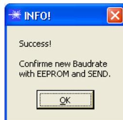
Nachdem die neue Baudrate erfolgreich übertragen worden ist arbeitet der Sensor mit der neuen Baudrate. Außerdem erscheint ein Popup mit der Aufforderung **EEPROM** zu selektieren und anschließend **SEND** zur drücken. Erst nach Drücken von **EEPROM** und **SEND** wird bei einem Hardware-Reset mit der neuen Baudrate gestartet.
